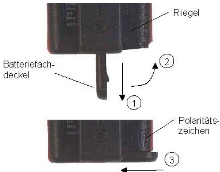
Wird der Meldeempfänger mit einem Akku betrieben, ist regelmäßig eine Nachladung im Ladegerät notwendig. Um eine lange Lebensdauer des Akkus zu erreichen sind folgende Punkte zu beachten:
